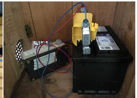
Ein umgebauter „MP3-Player“ spielt Abendseglerlockrufe in Dauerschleife
